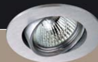
HD 766 kantelbaar halogeen 35 mm, 20-35W diameter 90 mm boorgat 76 mm
